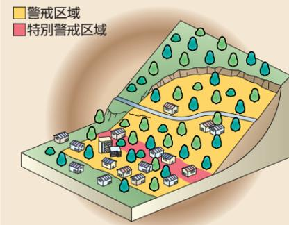
大雨や長雨等により雨水が地面にしみこみ、地下水の力によって持ち上げられた地面がゆっくりと斜面下方へ動き出す現象。一般的に広範囲にわたり動くため、甚大な被害を及ぼす可能性が高くなっています。
